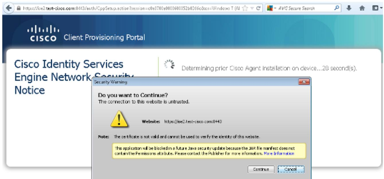
8. L'agent NAC est installé. Une fois l'agent NAC installé, il télécharge les règles de posture via le protocole SWISS et effectue des contrôles afin de déterminer la conformité. Le rapport de position est ensuite envoyé à l'ISE.
