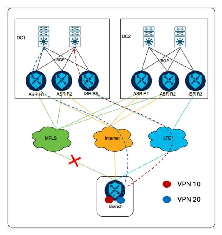
Pour le trafic de retour des commutateurs principaux, pour le trafic VPN 10, il est envoyé au routeur ISR cEdge car la longueur AS-PATH est plus petite via le routeur ISR que celle du routeur ASR, comme indiqué dans la section relative à la stratégie localisée. De même, le trafic VPN 20 est envoyé vers les périphéries ASR, car AS-PATH est plus petit via ASR par rapport à ISR.
