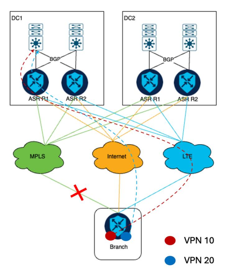
Dans ce scénario, le défi technique découle de l'échelle et des exigences spécifiques d'un déploiement réseau de clients. Compte tenu du déploiement de 3 000 routeurs SD-WAN établissant des tunnels IPSec via trois types de transport vers le routeur de data center, le nombre total de tunnels IPSec formés sur les routeurs de tête de réseau primaire ASR1002-HX atteint 9 000. Cependant, l'ASR1002-HX est limité à 8000 tunnels IPSec (source : fiche technique ASR1K).
