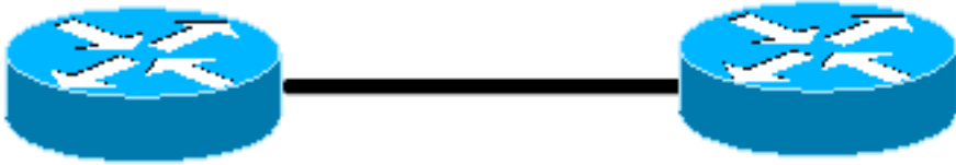
Figure 6 - Routeurs connectés dos à dos
