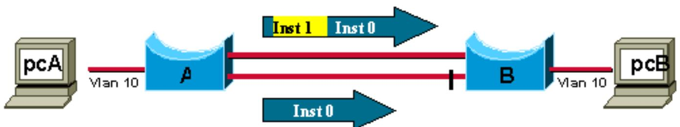
Le commutateur B reçoit deux BPDU pour l'instance 0 depuis le commutateur A (une sur chaque port). Il est clair que le commutateur B doit bloquer l'un de ses ports pour éviter une boucle.
