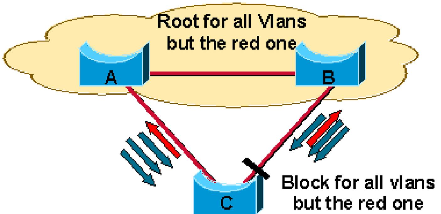
Une simulation qui échoue place le port à la limite en mode root inconsistant
