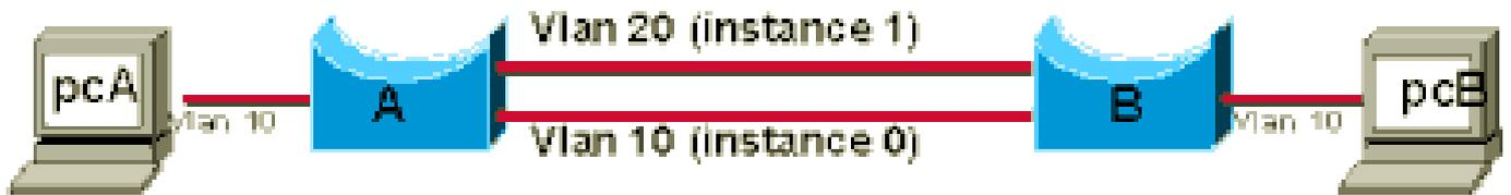
Cette configuration fait que pcA ne peut pas envoyer de trames à pcB. La commande show révèle que le commutateur B bloque la liaison au commutateur A dans le VLAN 10, comme illustré dans ce schéma :
