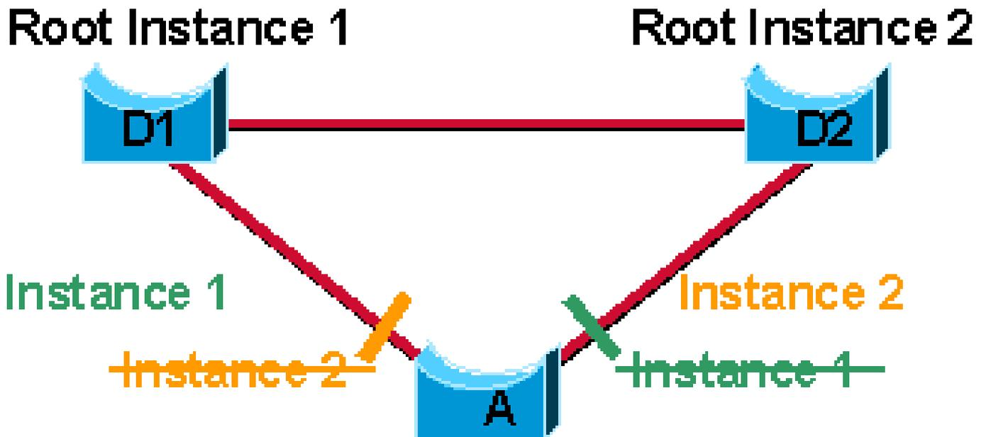
Mapper la moitié des 1000 VLAN à une instance Spanning Tree différente
