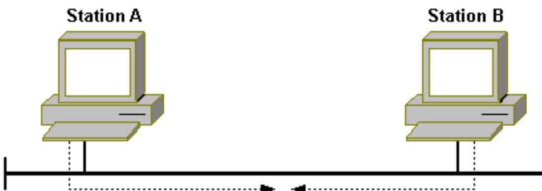
1. Station A souhaite envoyer une trame. D'abord, elle contrôle si le support est disponible (détection de porteuse). S'il ne l'est pas, elle attend jusqu'à ce que l'expéditeur actuel sur le support ait terminé.
