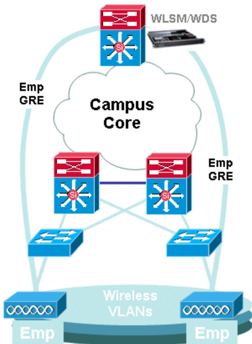
Notez qu'un VLAN est encore associé avec chaque SSID. Ces VLAN sont maintenant définis seulement sur le Point d'accès et n'ont pas besoin d'être configurés sur la couche d'accès ou les commutateurs de la couche de distribution. Le seul but de la partie VLAN de la configuration est de fournir une attache entre le cryptage associé avec le VLAN à une particularité SSID.
