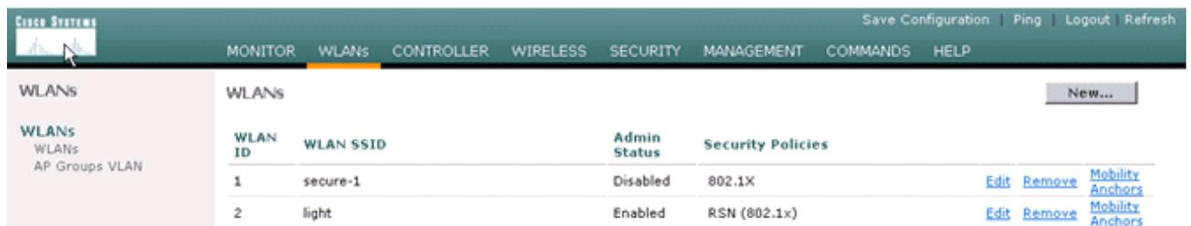
Si un nouveau SSID est utilisé, aucune autre configuration n'est exigée. Si un SSID existant est utilisé, améliorez seulement un domaine rf à la fois afin d'empêcher des questions de mobilité entre le Catalyst 6500 WSLM et le Catalyst 6500 WiSM. Une fois que les WLAN sont configurés, vérifiez si les stratégies WLAN sont correctes. Par exemple, ACL, QoS, et ainsi de suite. Assurez-vous que le Cisco WCS est en service et est prêt à être configuré pour gérer Cisco WiSM.
