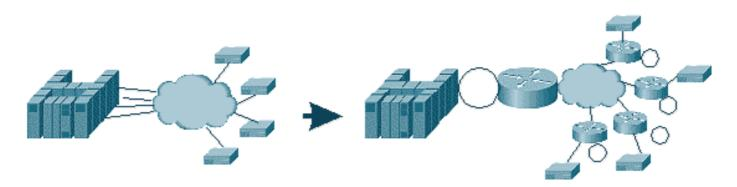
Les routeurs permettent au FEP de n'avoir que l'interface Token Ring. À partir de ce point, plusieurs emplacements distants exécutent SDLLC vers l'hôte, ainsi que le trafic SRB (Source-Route Bridge) régulier.
