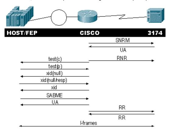
Vérifiez la réponse SNRM (Set Normal Response Mode) du contrôleur. Le routeur ne démarre pas la partie LLC tant que la partie SDLC n'est pas opérationnelle.
