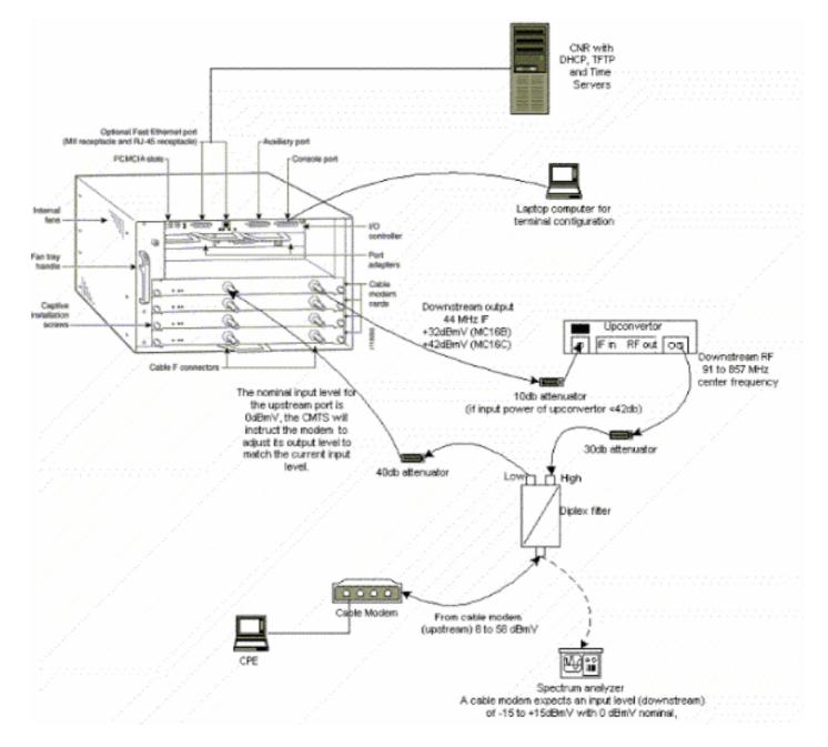
La configuration ci-dessus peut être utilisée à des fins de dépannage et exclut les problèmes de radiofréquences, car elle exclut les signaux de télévision par câble.
