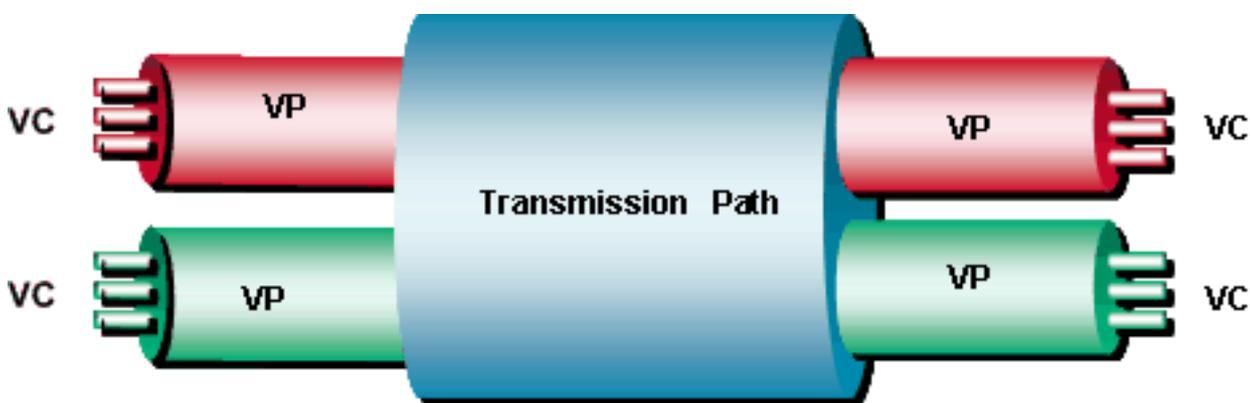
Dans le [diagramme](#) ci-dessus, les cellules ATM qui arrivent sur le circuit virtuel sont commutées en fonction du numéro VPI et VCI dans l'en-tête de cellule. Par contre, les cellules ATM qui arrivent sur le VP sont commutées en fonction du numéro VPI uniquement. La configuration du commutateur ATM détermine si le commutateur est censé être un commutateur VC ou VP pour une paire VPI/VCI ou VPI spécifique, respectivement.
