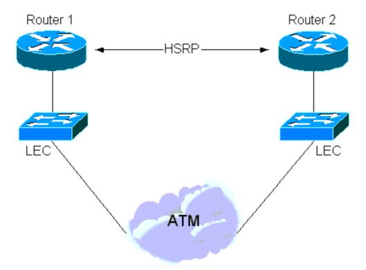
3. Enfin, il y a une situation « hybride » où certains routeurs HSRP sont connectés à un LAN et d'autres se trouvent sur un LAN derrière un commutateur LAN.
