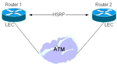
2. Il existe également une instance où HSRP est configuré sur les interfaces LAN, mais une partie du sous-réseau couvre un nuage LANE. Pour ce faire, vous devez utiliser l'intermédiaire d'un commutateur LAN avec une interface ATM (par exemple, un commutateur Cisco Catalyst 5000 avec un module LANE). Reportez-vous à l'illustration suivante.
