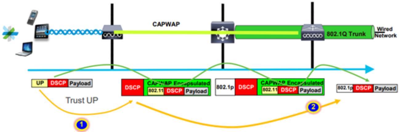
Para el escenario descendente, el switch donde el WLC está conectado agrega el valor 802.1p basado en la tabla de mapping DSCP-CoS configurada en él. Si elige confiar en la CoS, el valor DSCP externo se cambia en función del valor 802.1p entrante.
