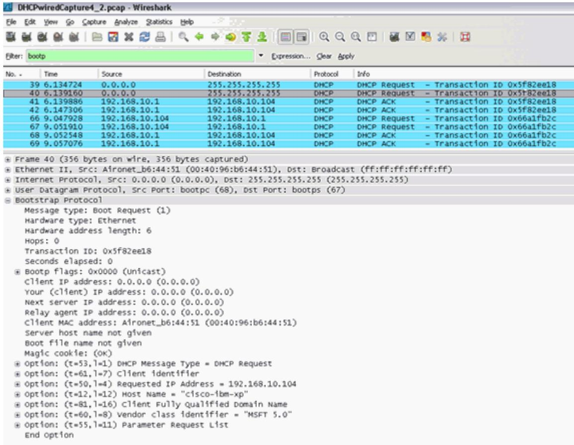
En la captura de pantalla de captura de paquetes cableados puede ver que el paquete 40 es la transmisión de la solicitud DHCP puenteada desde el cliente de prueba 00:40:96:b6:44:51 a la red cableada.
