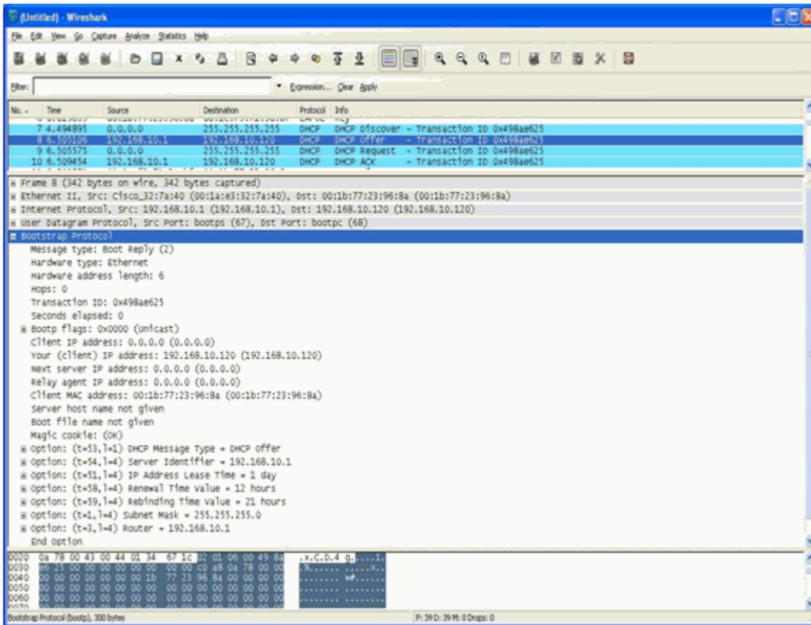
En la captura de pantalla de captura de paquetes del lado del cliente, la diferencia principal entre la captura del cliente en el modo Proxy es que la IP real del servidor DHCP se ve en los paquetes Offer y Ack en lugar de la dirección IP virtual del controlador.
