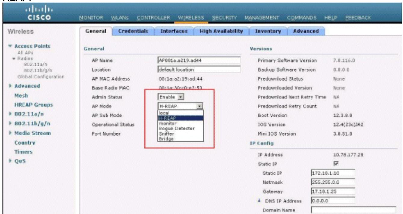
**Nota:** En este ejemplo, puede ver que la dirección IP del AP se cambia al modo estático y la dirección IP estática 172.18.1.10 se ha asignado. Esta asignación se produce porque ésta es la subred que se utilizará en la oficina remota. Por lo tanto, usted utiliza la dirección IP del servidor DHCP, pero sólo durante la primera vez a través de la etapa de registro. Después
