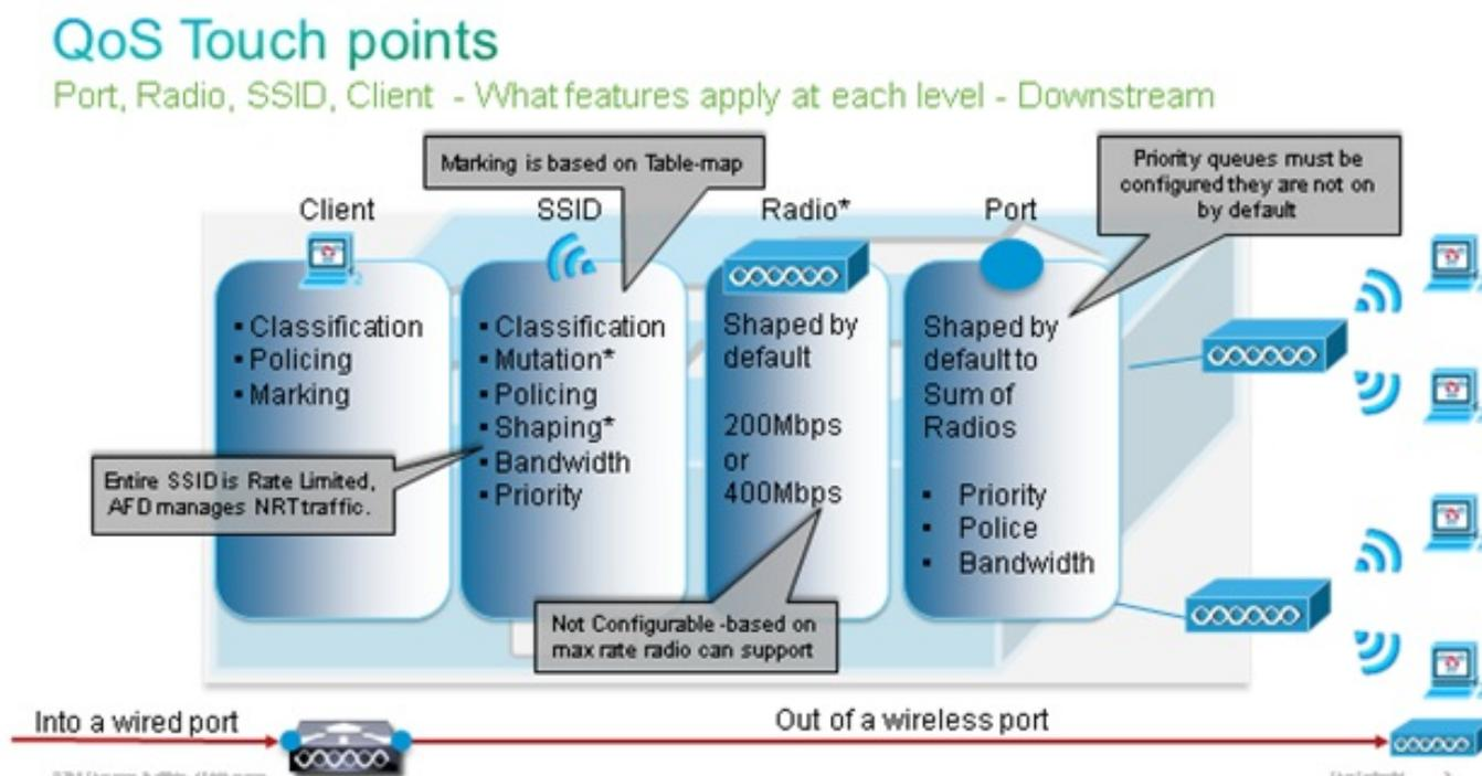
Este ejemplo de configuración se centra en el aspecto inalámbrico de la configuración de QoS y
