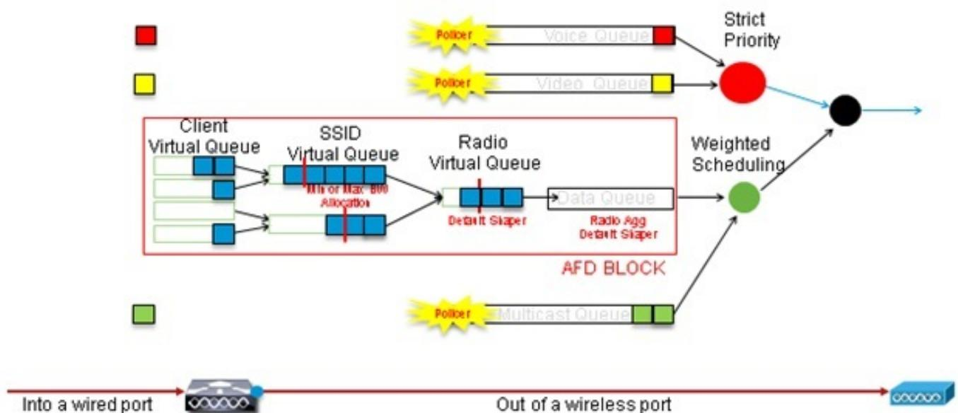
Este ejemplo de configuración coloca la voz en la primera cola prioritaria y el vídeo en la segunda cola de prioridad mediante el uso del comando **priority level**. El resto del tráfico se asigna al resto del ancho de banda del puerto.
