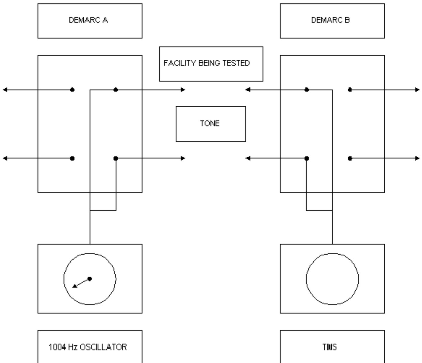
El equipo está configurado para probar el circuito entre la demarcación en A y la demarcación en B.
