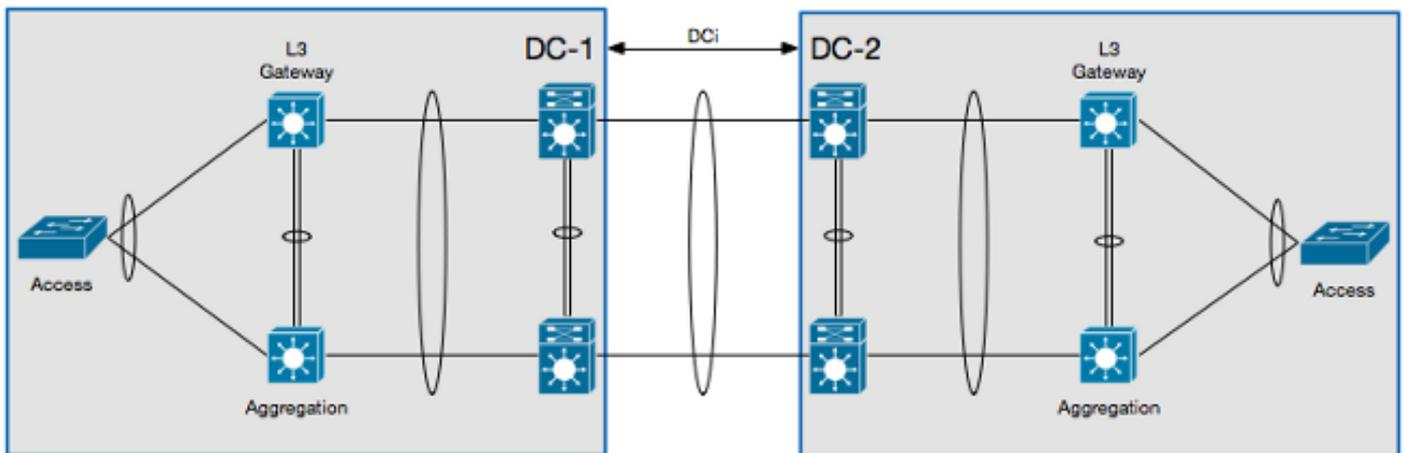
En este escenario, el DCI se aísla en su propio contexto del dispositivo virtual L2 (VDC), y el gateway L3 está en un dispositivo de la capa de la agregación. Para aislar el HSRP, usted debe configurar un VLAN Access Control List (VACL) ese los bloques el tráfico de control del HSRP y un filtro de la inspección ARP que bloquee el HSRP GARP en el L2 DCI VDC.
