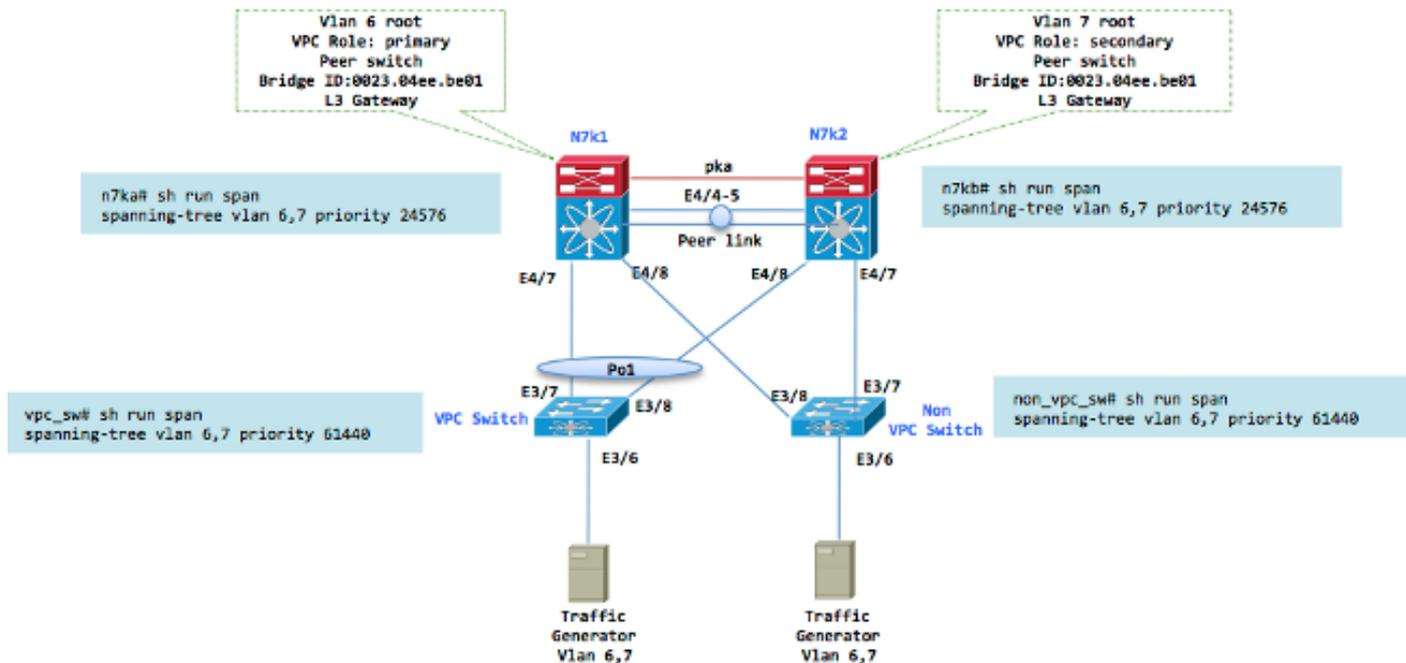
Un switch que no es de vPC ahora podría recibir una BPDU superior desde una trayectoria diferente que podría causar un cambio en el estado de reenvío de un link específico. El cambio de estado se muestra en el siguiente ejemplo de salida donde e3/7 ha pasado al estado de reenvío después del cambio del switch de peer. Dado que RSTP está en uso, este cambio de estado es inferior a un segundo. Sin embargo, se genera una Notificación de cambio de topología (TCN).
