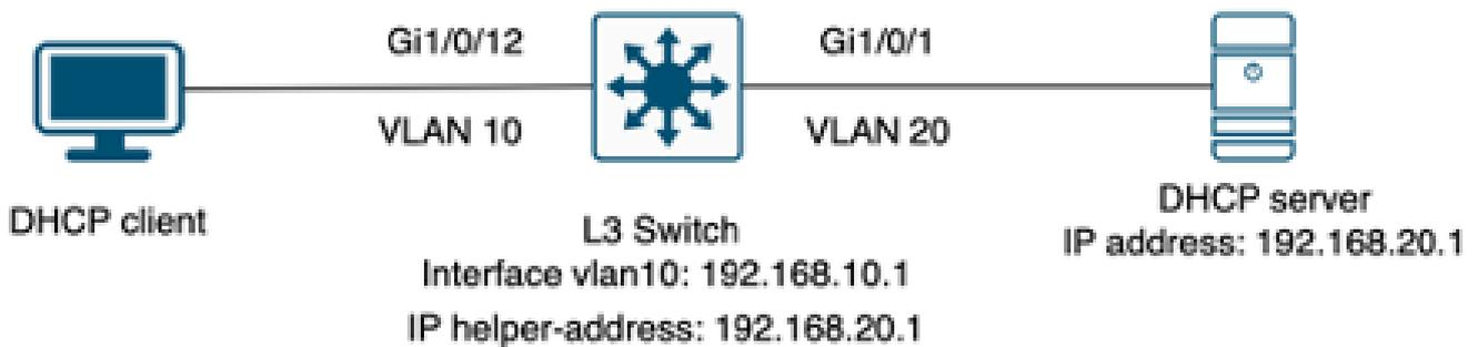
Cliente conectado a un switch de Capa 3 configurado como agente de retransmisión.
