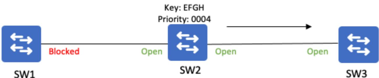
Este proceso se repite hasta que el puerto de mayor prioridad permanece en modo de bloqueo. Esto se convierte en el puerto alternativo del segmento. El puerto alternativo continúa enviando mensajes BPA que contienen su clave de puerto al segmento REP. Todos los puertos REP de la caché de segmentos muestran la clave del puerto alternativo.
