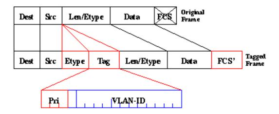
El campo EtherType que identifica la trama 802.1Q es 0x8100. Además del VLAN-ID de 12 bits, se reservan 3 bits para el etiquetado de prioridad IEEE 802.1p.
