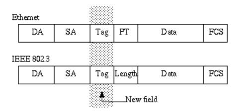
**Nota:** En un tronco 802.1Q, una VLAN NO está etiquetada. Esta VLAN, denominada VLAN nativa, debe configurarse de la misma forma en ambos lados del tronco. De esta manera, puede deducir a qué VLAN pertenece una trama cuando recibe una trama sin etiqueta.
