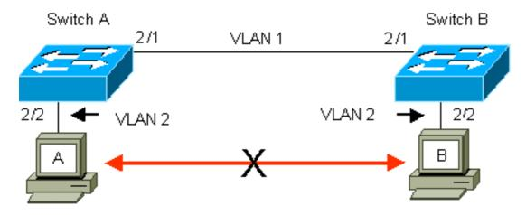
La solución es habilitar el enlace troncal ISL en el link entre los switches A y B. El enlace troncal agrega un encabezado VLAN a cada trama durante la transmisión (multiplex) a un link troncal. Esta adición permite que el switch en el otro extremo del link desmultiplique las tramas; el switch luego reenvía las tramas a los puertos VLAN apropiados.
