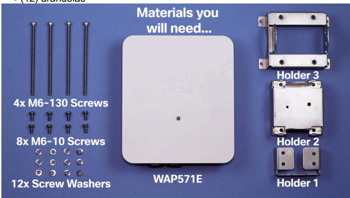
El primer paso del montaje en poste requiere un poste pequeño con un diámetro máximo de 3". Después de acoplar Holder\_1 al dispositivo, tome Holder\_2 y Holder\_3 y colóquelos en los extremos opuestos del poste. Con los tornillos y arandelas 4 M6\*130, fije los soportes de forma que estén fijos alrededor del poste. Por último, monte el dispositivo WAP571E en el
