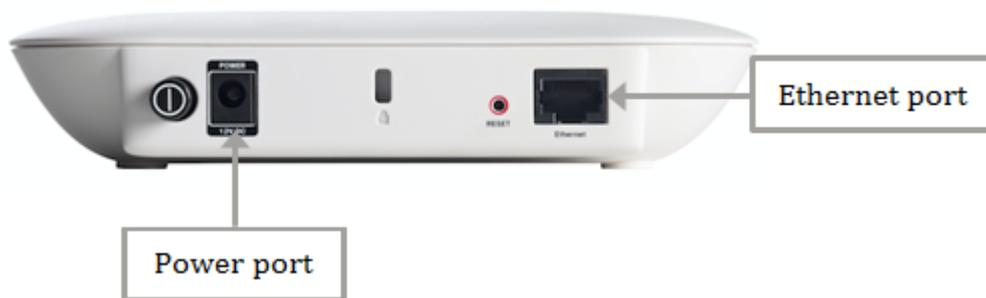
**Nota:** Tenga en cuenta el tipo de PoE que necesita su WAP para asegurarse de que recibe la fuente de alimentación completa del router o switch. Compruebe la documentación de sus dispositivos si es capaz de 802.3af o del estándar PoE de alta potencia 802.3at y verifique si su switch o router puede proporcionarlo al WAP. Para verificar la fuente de alimentación de PoE en su punto de acceso, haga clic [aquí](#).
