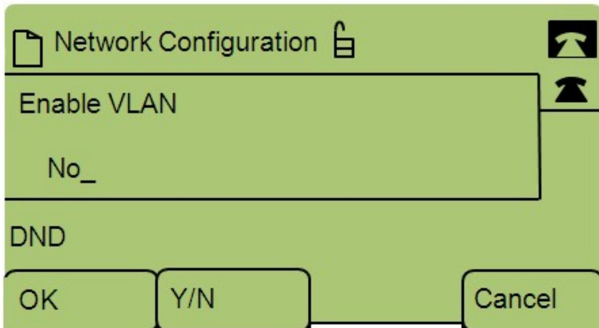
Paso 6. Presione **Y/N** para alternar entre Sí y No para habilitar o inhabilitar la VLAN.
