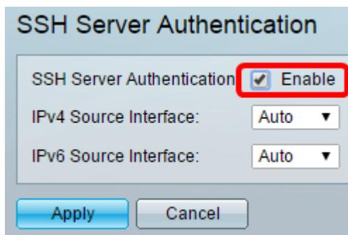
Paso 3. (Opcional) En la lista desplegable Interfaz de origen IPv4, elija la interfaz de origen cuya dirección IPv4 se utilizará como dirección IPv4 de origen para los mensajes utilizados en la comunicación con los servidores SSH IPv4.
