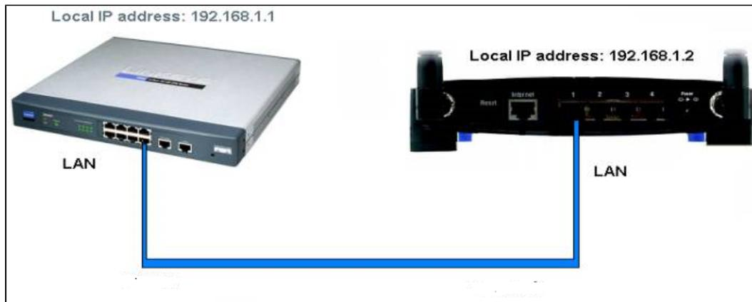
**Nota:** Si puede acceder a la GUI de ambos routers desde el PC que está conectado a cualquiera de los routers, los routers se conectarán en cascada correctamente.
