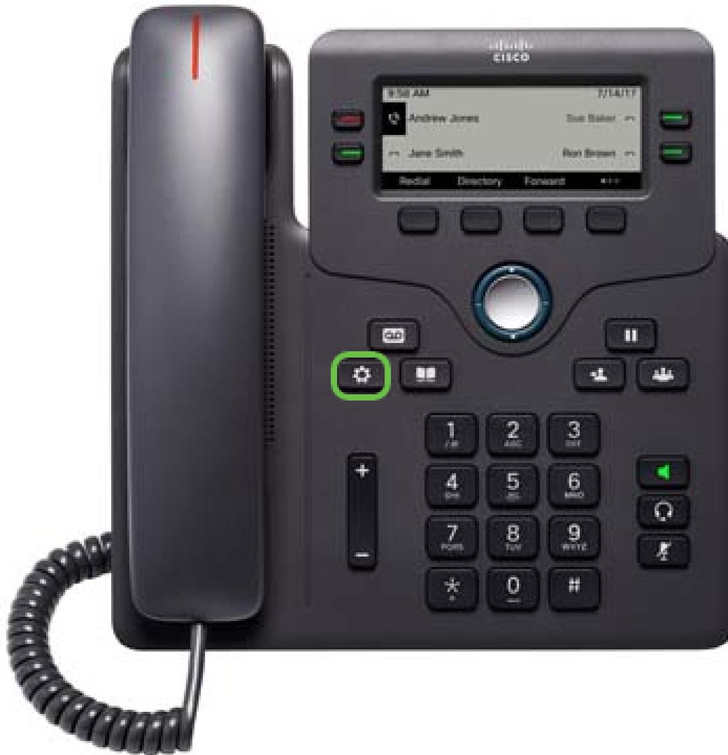
Paso 2. Con el botón del grupo de navegación
