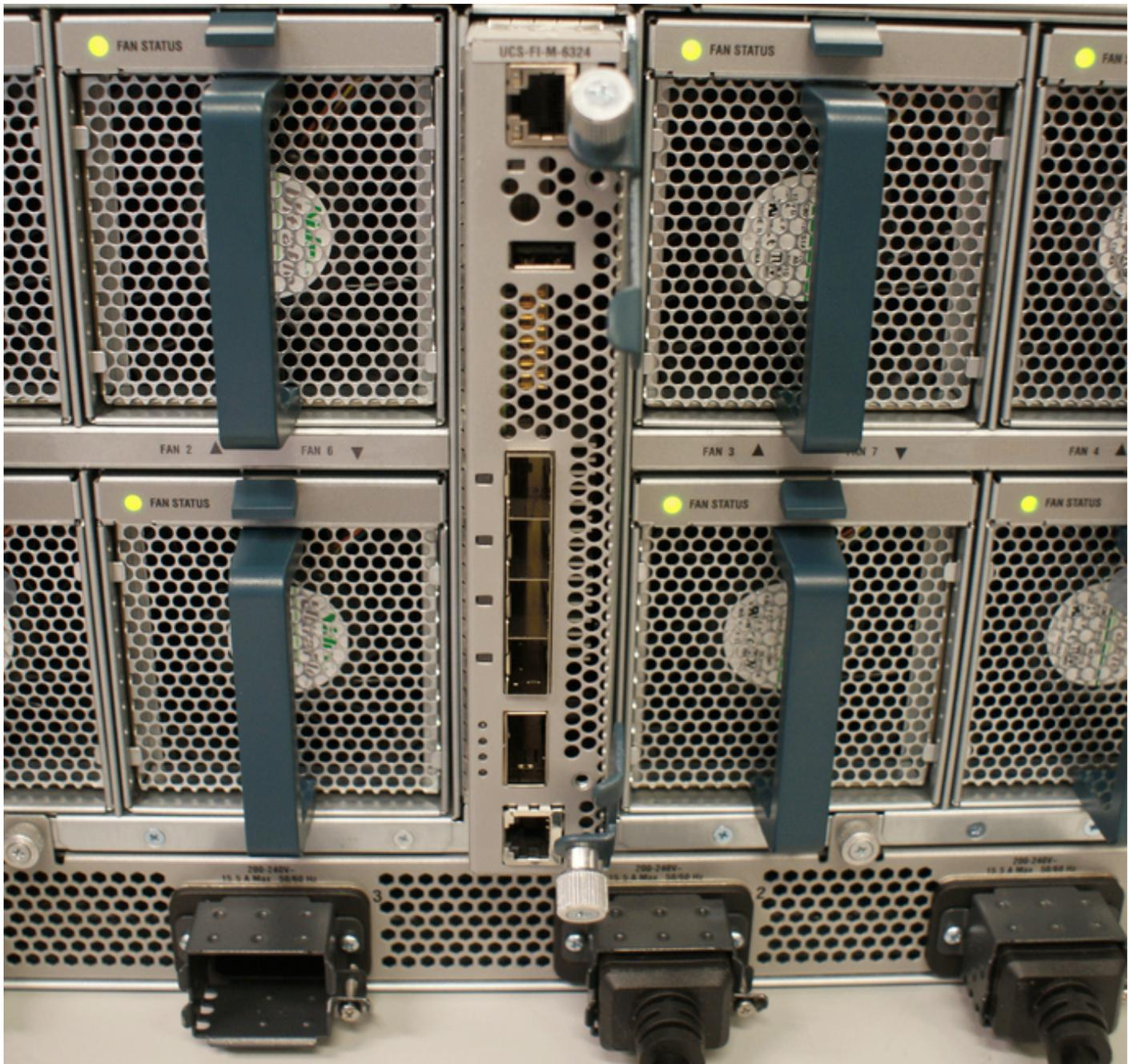
La interfaz de 40 Gbit (puerto de escalabilidad) se puede utilizar con un cable multiconector que se transforma a 4 cables de 10 Gbit.
