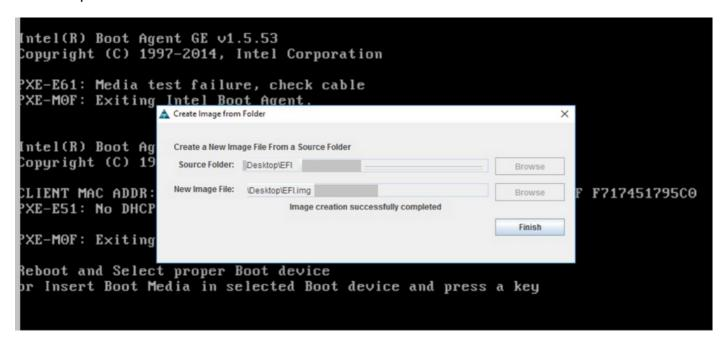
Nota: El KVM basado en JAVA se utilizó aquí para convertir de storcli.efi a EFI.IMG.
