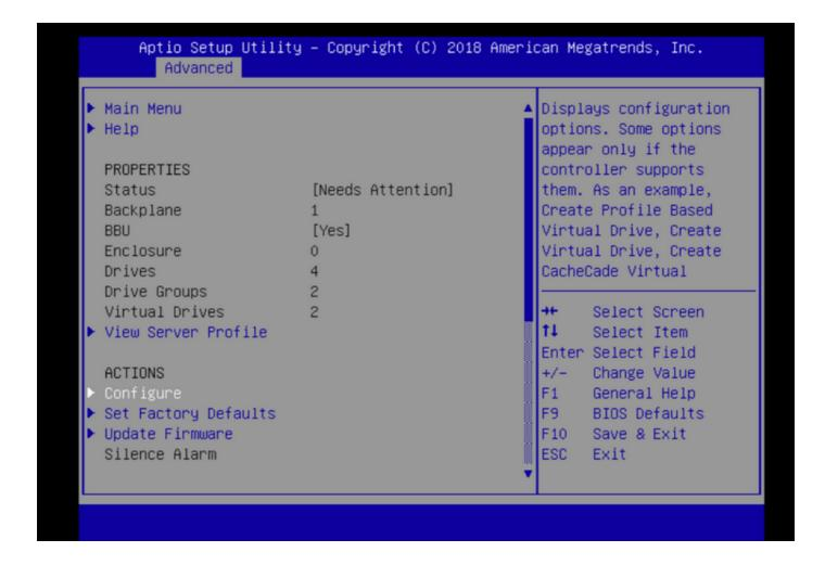
**Nota:** Antes de sustituir el controlador RAID, el VD debe ser óptimo y accesible desde el host.
