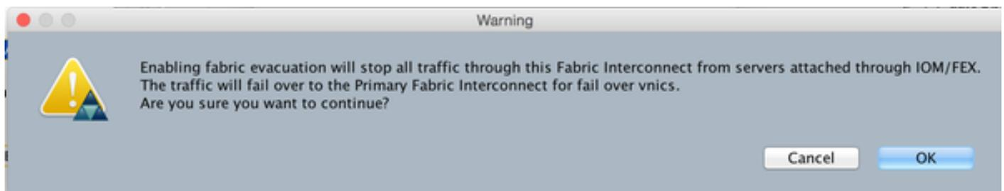
4. Haga Click en OK para confirmar la evacuación del tráfico de la tela. Usted observará que los vNICs configurados con la Conmutación por falla de la tela tráfico del repin a la tela alterna. Confirme en el sistema operativo del host que el tráfico está fluyendo en la tela alterna.
