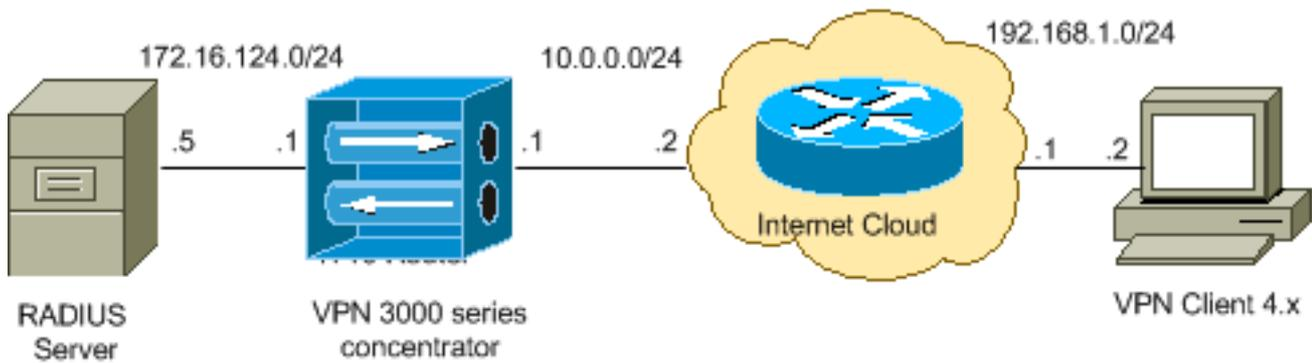
**Nota:** Los esquemas de direccionamiento IP utilizados en esta configuración no son legalmente enrutables en Internet. Son [direcciones RFC 1918](#) que se han utilizado en un entorno de laboratorio.
