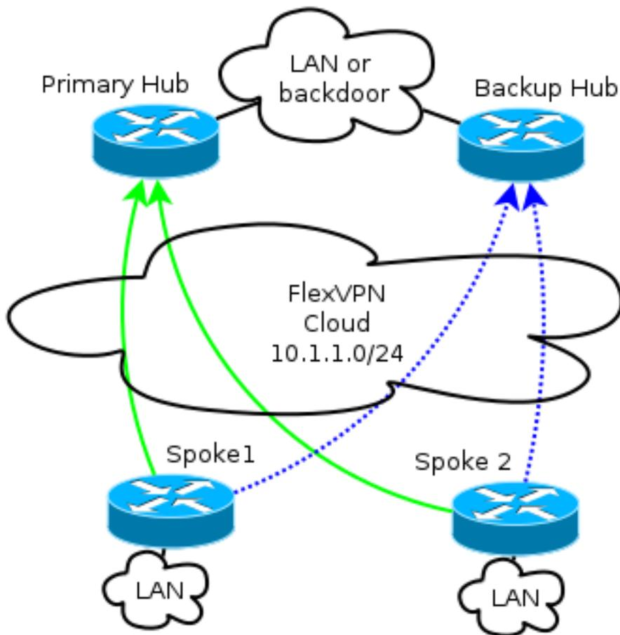
**Nota:** En el diagrama, las líneas verdes sólidas muestran la conexión y dirección de las sesiones principales de Intercambio de claves de Internet versión 2 (IKEv2)/Flex, y las líneas azules punteadas indican la conexión de respaldo en caso de que falle la sesión de Intercambio de claves de Internet (IKE) al hub principal.
