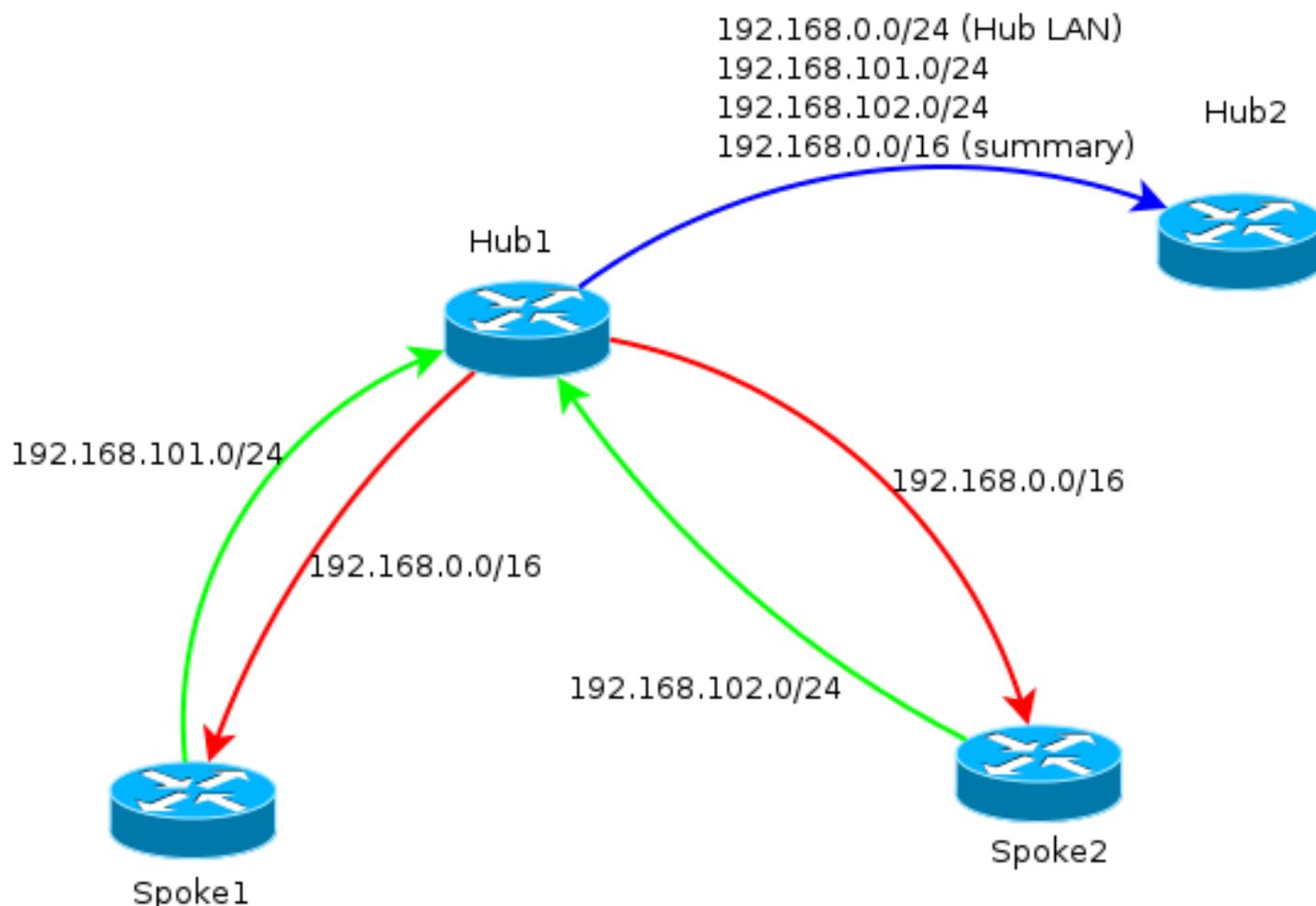
**Nota:** En el diagrama, la línea verde representa la información proporcionada por los radios al hub, la línea roja representa la información proporcionada por cada hub a los radios (sólo un resumen) y la línea azul representa los prefijos intercambiados entre ejes.
