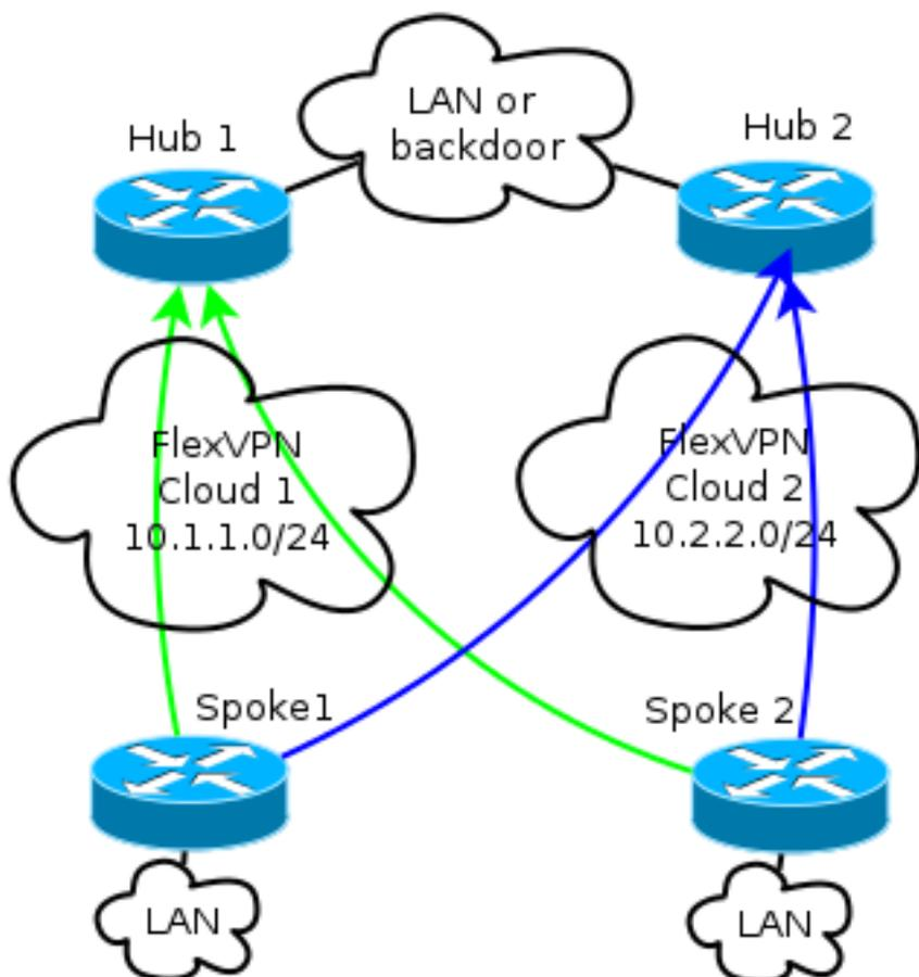
**Nota:** En el diagrama, las líneas verdes muestran la conexión y la dirección de las sesiones de intercambio de claves de Internet versión 2 (IKEv2)/Flex al Hub 1, y las líneas azules indican la conexión al Hub 2.
