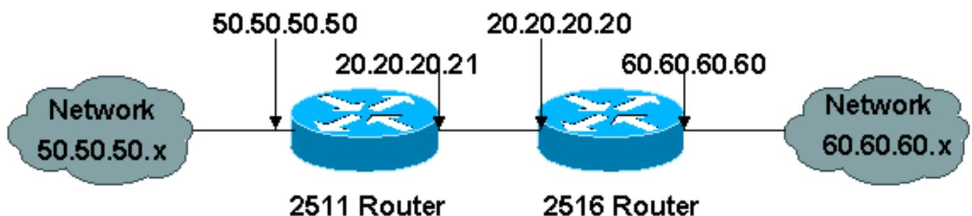
A continuación se muestran las configuraciones de dos routers (un Cisco 2511 y un Cisco 2516) adosados que realizan autenticación IPsec e ISAKMP basada en una clave previamente compartida. Las líneas de comentario se indican con un signo de exclamación como el primer carácter y se ignoran si se ingresan en el router. En la siguiente configuración, los comentarios preceden a ciertas líneas de configuración para describirlas.
