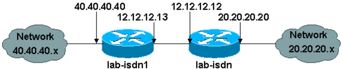
La siguiente configuración de ejemplo se toma de dos routers Cisco 1600 que han obtenido certificados CA previamente (como se muestra anteriormente) y pretenden hacer ISAKMP con "rsa-sig" como política de autenticación. Sólo se cifra el tráfico entre las dos LAN Ethernet remotas.
