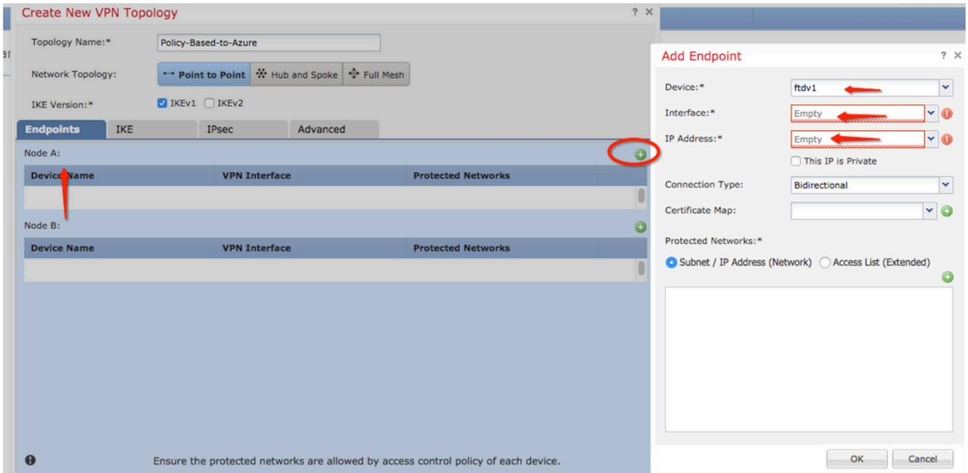
Paso 10. En el **Add Endpoint** , especifique el FTD que se utilizará en el **Device** junto con su interfaz física y la dirección IP que se utilizará.
