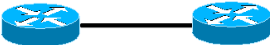
Figura 6: Routers conectados adosados
