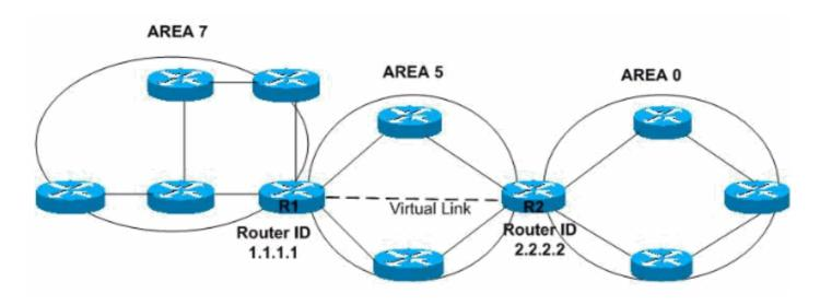
En este ejemplo, se crea un link virtual entre los routers con ID de router 1.1.1.1 y con ID de router 2.2.2.2. Para crear el link virtual, configure el area 5 virtual-link 2.2.2.2 subcomando en el router 1.1.1.1 y en el area 5 virtual-link 1.1.1.1 subcomando en el router 2.2.2.2. Consulte Configuración de la autenticación OSPF en un enlace virtual para obtener más información.
