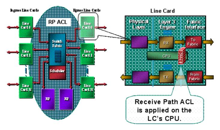
Se requiere un mecanismo de protección para el GRP. Las rACL afectan el tráfico que se envía al GRP debido a las adyacencias de recepción. Las adyacencias de recepción son adyacencias de Cisco Express Forwarding para el tráfico destinado a las direcciones IP del router, como la dirección de broadcast o las direcciones configuradas en las interfaces del router. Consulte la sección del apéndice para obtener más detalles sobre las adyacencias de recepción y los paquetes punteados.
