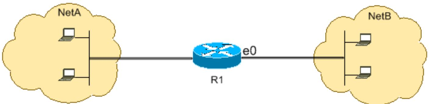
Telnet utiliza TCP, puerto 23. Esta configuración muestra que todo el tráfico TCP destinado a NetA para el puerto 23 está bloqueado y se permite el resto del tráfico IP.
