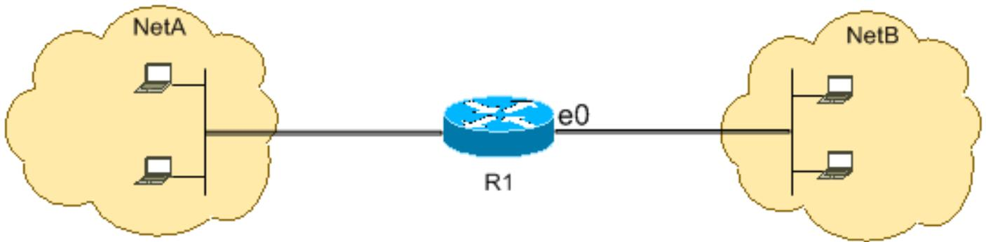
Esta configuración permite el tráfico TCP con el valor de puerto de destino 53. La cláusula deny all implícita al final de una ACL deniega el resto del tráfico, que no coincide con las cláusulas permit.
