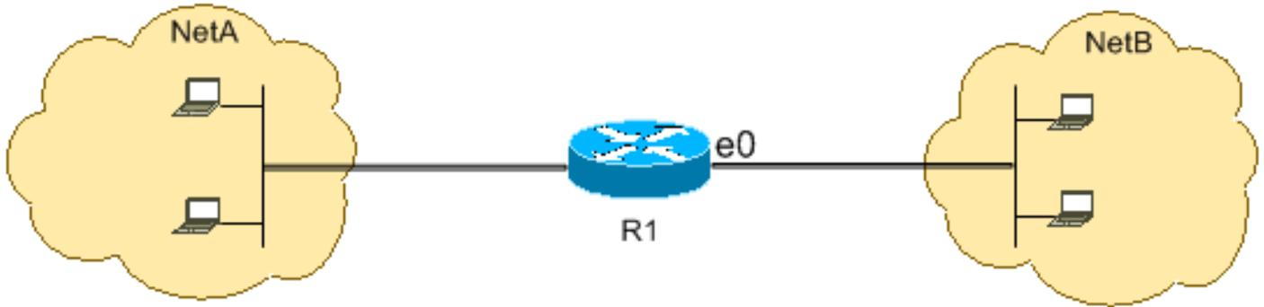
FTP utiliza el puerto 21 y el puerto 20. El tráfico TCP destinado al puerto 21 y al puerto 20 se deniega y todo lo demás se permite explícitamente.
