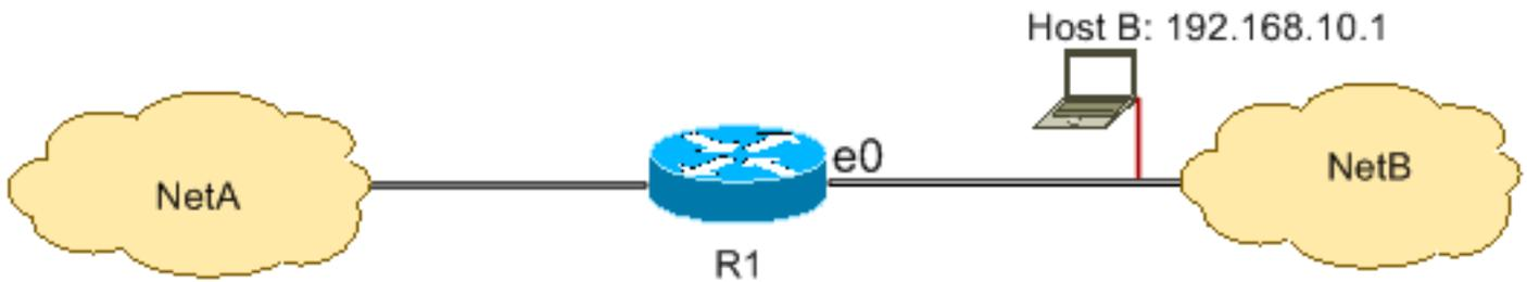
Esta configuración niega todos los paquetes del host 192.168.10.1/32 a través de Ethernet 0 en R1 y permite todo lo demás. Debe utilizar el comando access list 1 permit any para permitir explícitamente todo lo demás porque hay una cláusula total de negación implícita con cada ACL.
