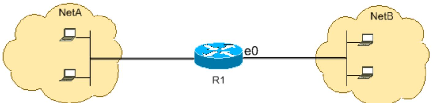
Esta configuración permite que solo los paquetes de respuesta de eco (respuesta de ping) lleguen en la interfaz Ethernet 0 desde la Red B hacia la Red A. Sin embargo, la configuración bloquea todos los paquetes ICMP de solicitud de eco cuando los pings se originan en la Red B y se destinan a la Red A. Por lo tanto, los hosts en la Red A pueden hacer ping con los hosts en la Red B, pero los hosts en la Red B no pueden hacer ping con los hosts en la Red A.
