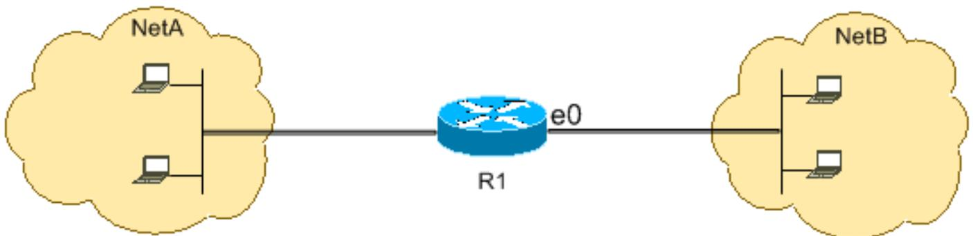
Esta configuración permite el tráfico TCP con valores de puerto de destino que coincidan con datos FTP (puerto 20), FTP (puerto 21), POP3 (puerto 110), SMTP (puerto 25), Telnet (puerto 23) y WWW (puerto 80). Tenga en cuenta que una cláusula total de negación implícita al final de una ACL niega el resto del tráfico, que no coincide con las cláusulas de permiso.
