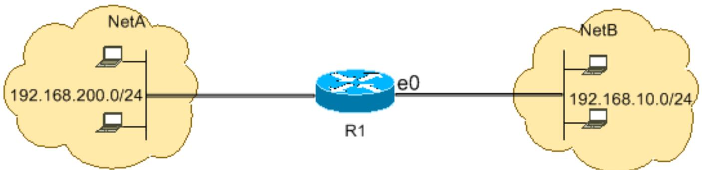
Esta configuración permite que los paquetes IP con un encabezado IP que tengan una dirección de origen en la red 192.168.10.0/24 y una dirección de destino en la red 192.168.200.0/24 accedan a la Red A. Hay una cláusula total de negación implícita al final de la ACL que niega el paso del resto del tráfico a través de Ethernet 0 entrante en R1.
