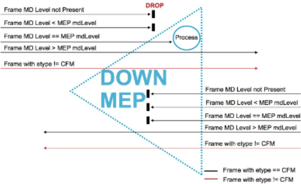
Colocación de MP en un puerto de puente
