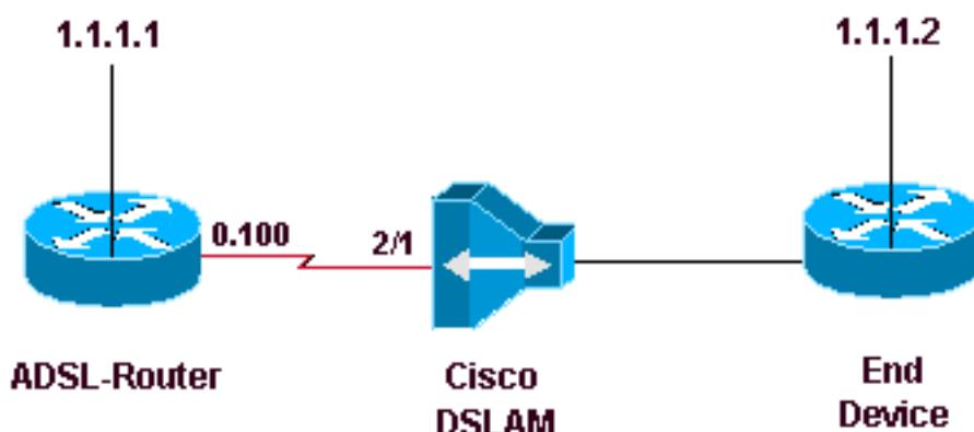
El router ADSL es un router 827 que ejecuta 12.2(8)YM
