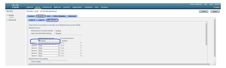
Wechseln Sie zur Registerkarte **Erweitert**, und aktivieren Sie "AAA-Außerkraftsetzung zulassen", und ändern Sie den "NAC-Status" in "ISE NAC".
