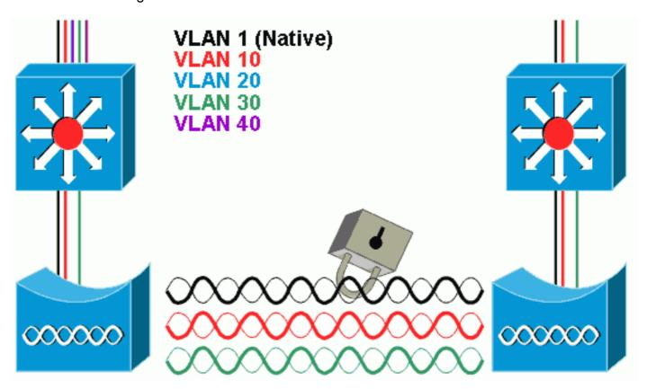
Um Daten zu verschlüsseln, die über die Funkverbindung übertragen werden, wenden Sie die Verschlüsselung nur auf die SSID des nativen VLAN an. Diese Verschlüsselung gilt für alle anderen VLANs. Bei der Bridge muss keinem VLAN ein separater SSID zugewiesen werden. Die VLAN-Konfigurationen sind auf den Root- und Nicht-Root-Bridges identisch.
