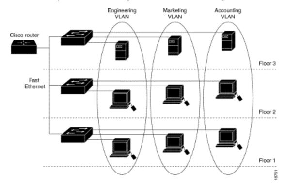
Wenn die Anzahl der Ports in einem Netzwerk die Port-Kapazität des Switches übersteigt, müssen Sie mehrere Switch-Chassis miteinander verbinden, was einen Trunk definiert. Der Trunk ist kein Mitglied eines VLANs, sondern ein Kanal, über den der Datenverkehr für ein oder mehrere VLANs geleitet wird.
