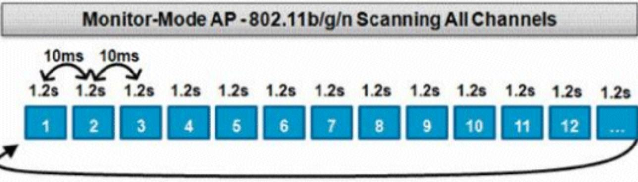
Diese Grafik zeigt den Off-Channel-Scan-Algorithmus für einen Überwachungsmodus AP im 2,4 GHz Frequenzband. Ein ähnlicher Vorgang wird parallel auf dem 5-GHz-Funkmodul durchgeführt, wenn ein AP vorhanden ist.
