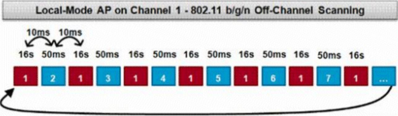
Diese Grafik zeigt den Off-Channel-Scan-Algorithmus für einen lokalen Modus AP im 2,4 GHz Frequenzband. Ein ähnlicher Vorgang wird parallel auf dem 5-GHz-Funkmodul durchgeführt, wenn ein AP vorhanden ist. Jedes rote Quadrat stellt die Zeit dar, die für den Hauptkanal der Access Points aufgewendet wurde, während jedes blaue Quadrat die Zeit darstellt, die für Scanzwecke auf benachbarten Kanälen aufgewendet wurde.
