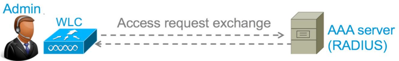
Schritt 1: Der WLC sendet eine Zugriffsanforderungsnachricht an den Radius-Server zusammen mit den Parametern, die im Befehl **test aaa radius** angegeben sind.
