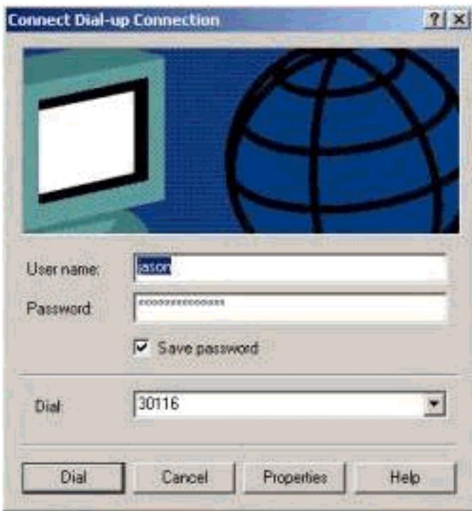
Nachdem die DFÜ-Verbindung hergestellt wurde, wird eine IP-Adresse aus dem im Router konfigurierten DFÜ-Pool zugewiesen. Sie können dies überprüfen, indem Sie den Befehl **ipconfig** im Host eingeben. Sie wird als PPP-Adapter im Host angezeigt.
