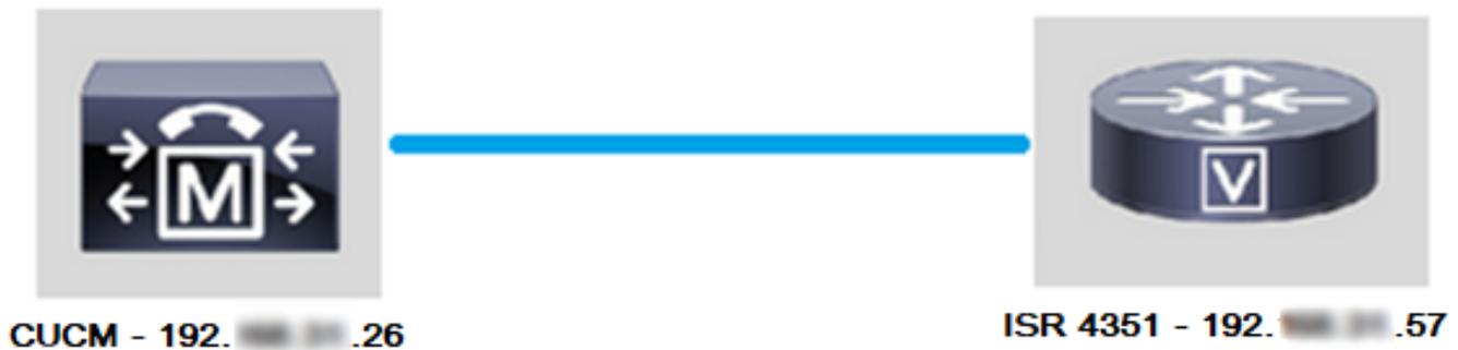
Damit der CUCM einen Anruf aus einem SIP-Trunk verlängern kann, erstellt er weiterhin einen Transmission Control Protocol (TCP)-Handshake mit 3-Wege-Handshake mit der IP-Adresse, die auf der Seite "Trunk Configuration" (Trunk-Konfiguration) angegeben ist, wie im Bild gezeigt:
