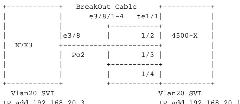
In diesem Beispiel ist ein Breakout-Kabel an die Ethernet-Schnittstelle 3/8 angeschlossen, die den 40-Gigabit-Port in vier 10-Gigabit-Ports unterteilt. Die erforderliche Konfiguration ist in diesem Abschnitt als Referenz enthalten.
