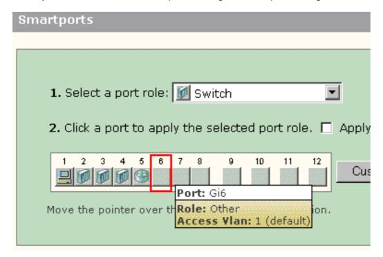
Bevor Sie Smartports verwenden, entscheiden Sie, welchen Switch-Port Sie für welchen Gerätetyp verwenden möchten. Sie können eine Smartports-Rolle auf einen <u>bestimmten Port</u> oder auf <u>alle Ports</u> des Switches anwenden.
