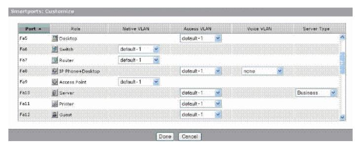
Wenn Ihr Netzwerk eine Trennung von Sprach- und Gastdatenverkehr bzw. eine Trennung vorsieht, müssen Sie zusätzliche VLANs erstellen. Wenn Sie zusätzliche VLANs auf dem Switch erstellen, auf dem IP-Telefon+Desktop und Voice Smartports installiert sind, müssen Sie außerdem folgende VLANs erstellen:
