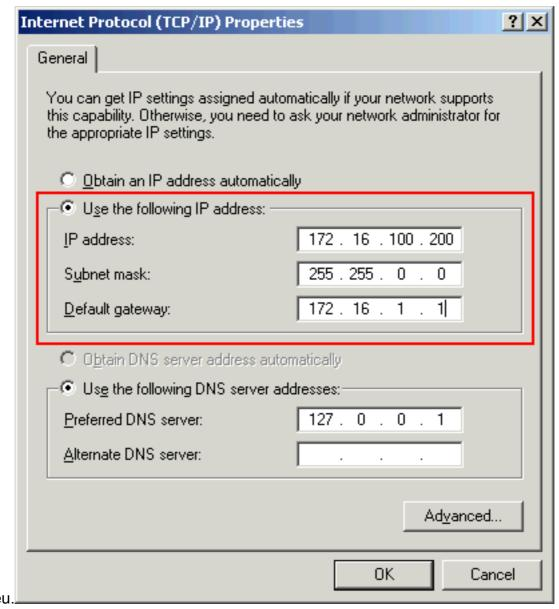
12. Wenn der Switch hochgefahren wird, öffnen Sie einen Webbrowser und gehen Sie zu http://<CE500\_Management\_IP\_Address>. Beispiel: http://172.16.100.100.Hinweis: Sobald die Erstkonfiguration abgeschlossen ist, kann der Switch über jeden Switch-Port verwaltet werden, der für dasselbe VLAN wie die IP-Adresse des Managements konfiguriert ist.
