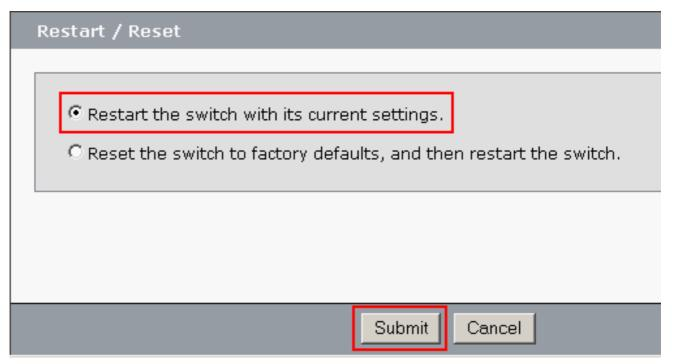
Der Switch wird automatisch in 60 Sekunden neu geladen. Ein Zähler zeigt die Zeit an, die für das erneute Laden verbleibt.
