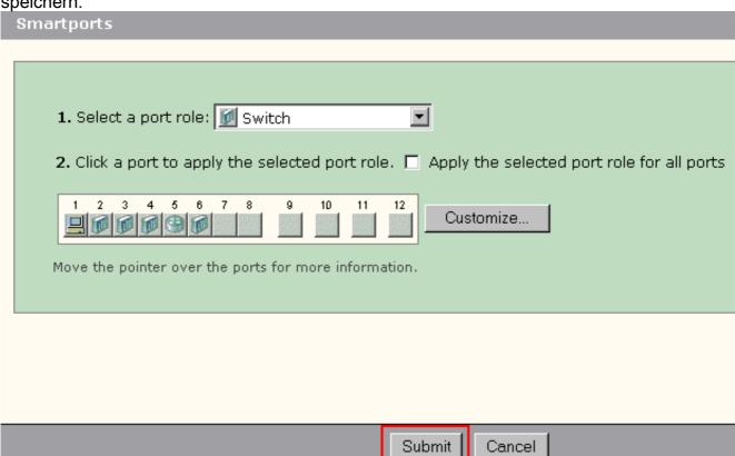
Gehen Sie wie folgt vor, um die auf einen Port angewendete Smartports-Rolle zu entfernen:
