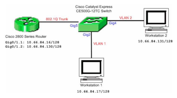
**Hinweis:** Bei der Beispielkonfiguration wird der Cisco Router der Serie 2800 verwendet. Dies kann durch jeden Cisco Router ersetzt werden, der IEEE 802.1Q-Trunking unterstützt.
