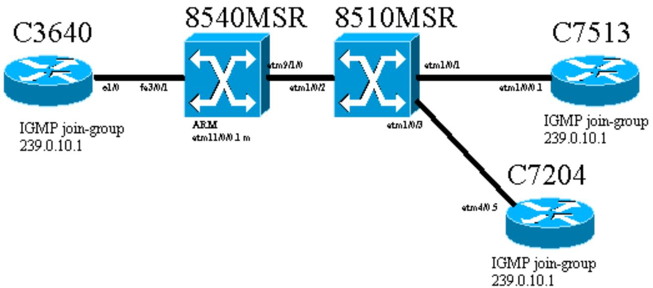
Der Cisco 3640 Router, der C3640, ist über den Fast Ethernet-Port 3/0/1 mit dem Cisco Catalyst 8540 MSR (auch als 8540MSR bezeichnet) verbunden. Die 8540MSR verfügt über ein ARM in Steckplatz 11. Der C8540MSR ist physisch mit dem 8510MSR über die **Schnittstelle ATM 9/1/0** verbunden. Der 8510MSR ATM-Switch ist über die ATM-Schnittstelle 1/0/2 mit dem 8540MSR verbunden.
